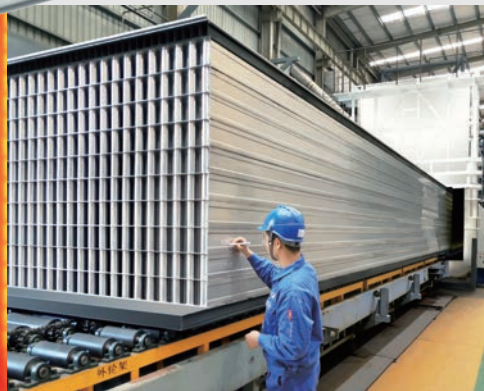
热风铜钎焊炉，一炉焊接芯板 240\text{m}^2 一条线一天生产12炉
